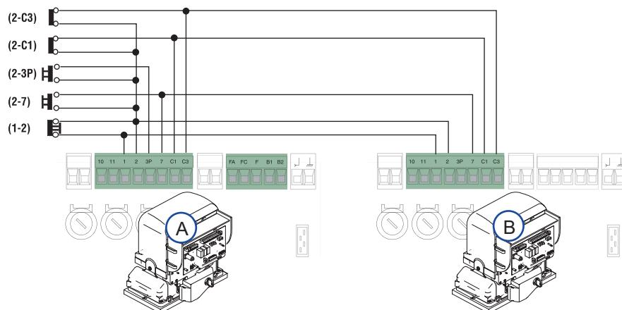
4) Выполнить подключения между блоками управления двух приводов, как показано на рисунке.
