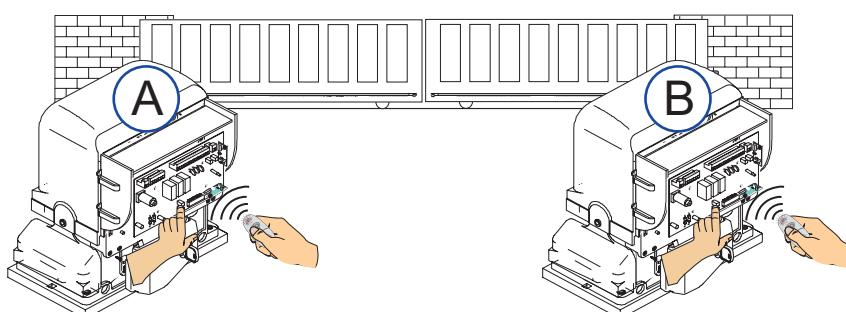
6) Для активации системы дистанционной разблокировки на обоих приводах, установить в каждый радиоприемник (разъем AF2). Выполнить запись кода системы "Pratico" на обоих блоках управления (раздел 8, стр. 14).
