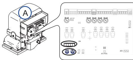
2) Выполнить электрические подключения блока управления привода А (см. раздел 6.3 "Электрические подключения")
